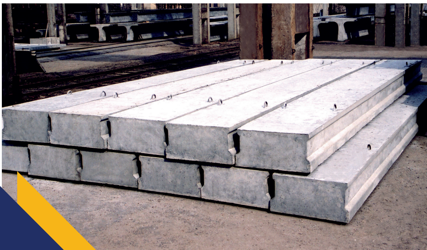
Плиты пролетного строения
