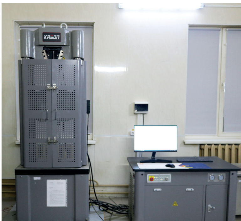
Оборудование по испытанию арматуры
