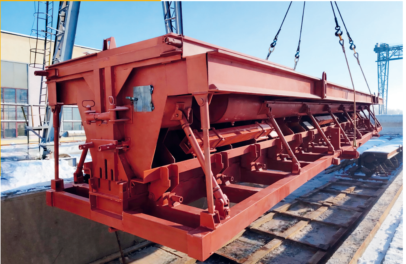
Внедрение новейших современных форм для производства балок длиной 33 м
